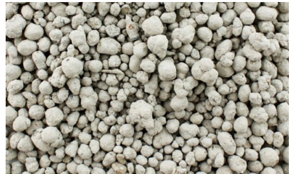
Pellets à base de mâchefers d'incinération d'ordures ménagères
