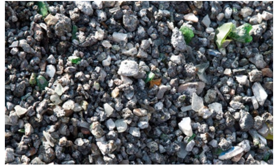
Graves de mâchefers lavés : ne contiennent ni boue ni polluant
